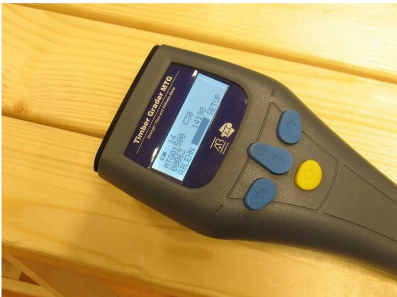
MTG má LCD displej s podsvícením, klávesnici a ergonomicky tvarovanou rukojeť.
