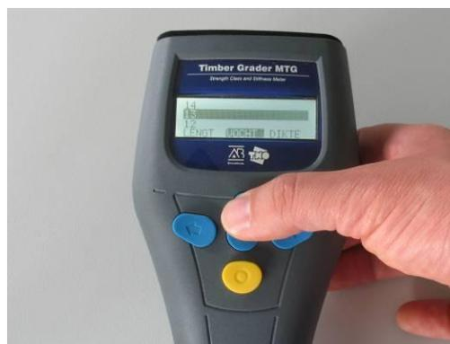
Stisknutím žlutého tlačítka se změněné nastavení přijme / akceptuje a uloží. Vlhkost na displeji dřevotřídiče MTG se v tomto příkladu změní z 12% na 13%.
