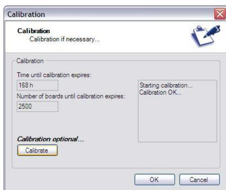
Pokud je kalibrace provedena správně objeví se na displeji dřevotřídiče MTG oznámení "CALIBRATION OK" (" KALIBRACE OK ").
