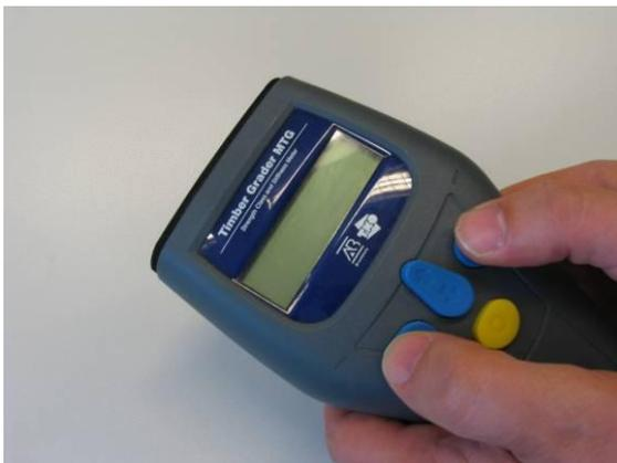
Zapněte nebo vypněte dřevotřídíč MTG stiskem levého a pravého kurzorového tlačítka současně. Když se tlačítka uvolní, dřevotřídíč MTG se zapne a displej se rozsvítí. Jakmile se dřevotřídíč MTG zapne, začne automaticky vyhledávat spojení se softwarem dřevotřídíče ( Timber Grader software) pomocí připojení Bluetooth. Jakmile je spojení navázáno, ozve se zvuk “pípnutí” (jednou). Na displeji dřevotřídíče MTG se zobrazí následující:
